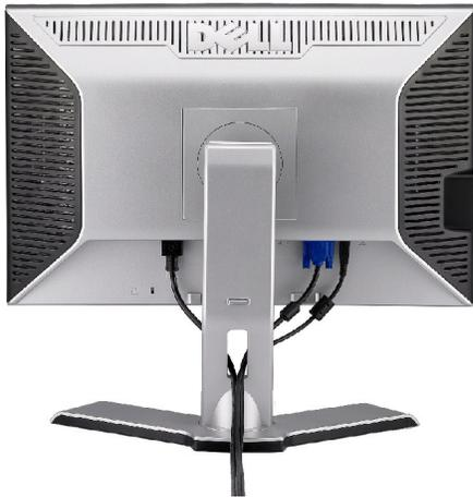
Verwenden Sie nach dem Anbringen aller erforderlichen Kabel an Ihren Monitor und den Computer (siehe [Anschließen Ihres Monitors](#) für Hinweise über das Anschließen der Kabel) den Kabelhalter, um sämtliche Kabel wie oben abgebildet sauber zu verlegen.
